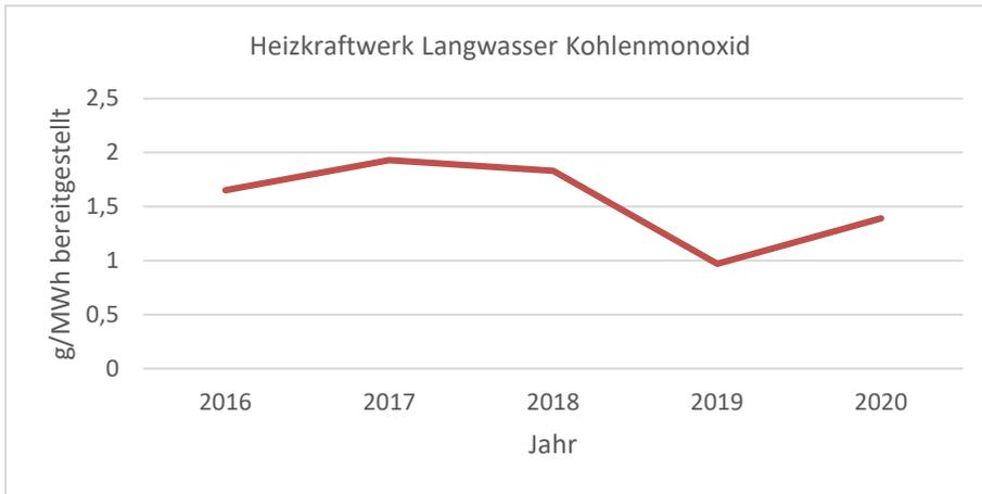
Wegen Umbau der Gasstation musste das Heizkraftwerk Langwasser über einen längeren Zeitraum mit Heizöl EL betrieben werden. Dadurch ist der leichte Anstieg an Kohlenmonoxid zu erklären.
