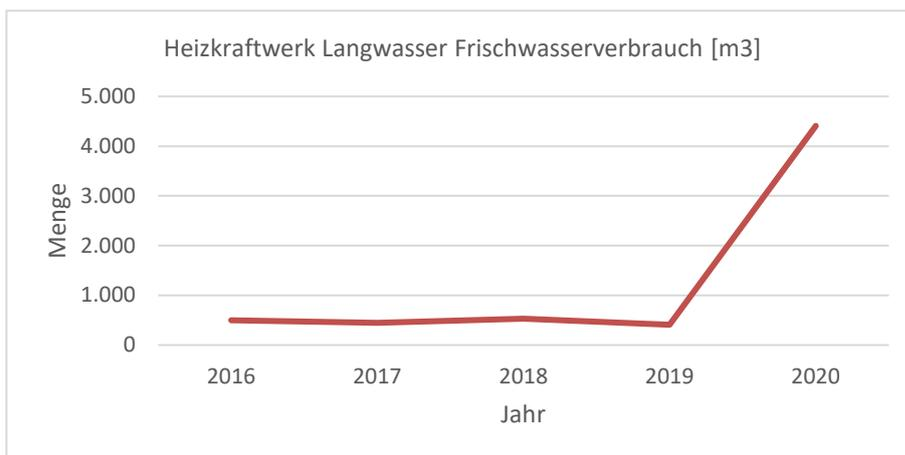
Der Wasserverbrauch im Heizkraftwerk Langwasser ist gegenüber 2019 von 408 m<sup>3</sup> auf 4.408 m<sup>3</sup> gestiegen. Dies ist darauf zurückzuführen, dass die Ostleitung, welche vom HKW aus
