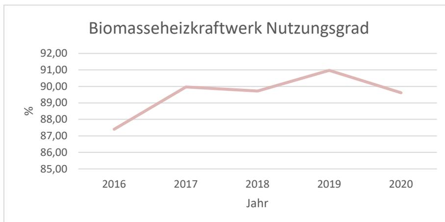
Da der Brennstoff naturbelassenes Holz ist, welches aus unterschiedlicher Qualität besteht, ist der Primärenergieeinsatz leicht gestiegen, während die erzeugte Energie gleich geblieben ist. Dadurch ist ein leicht sinkender Nutzungsgrad gegenüber 2019 zu verzeichnen.
