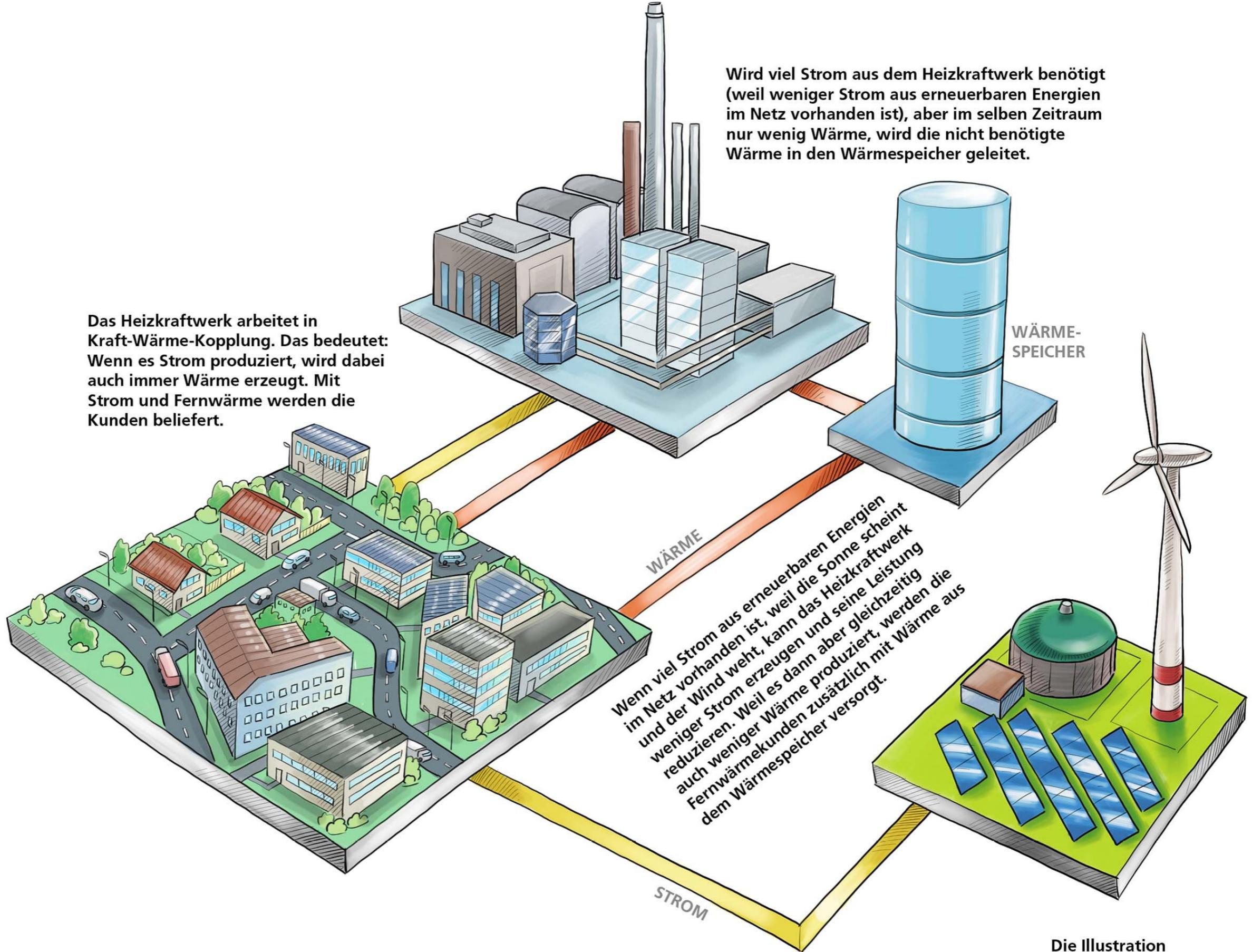
Das Heizkraftwerk arbeitet in Kraft-Wärme-Kopplung. Das bedeutet: Wenn es Strom produziert, wird dabei auch immer Wärme erzeugt. Mit Strom und Fernwärme werden die Kunden beliefert.
